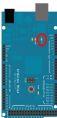
Die eingebaute LED ist an PIN 13 angeschlossen
